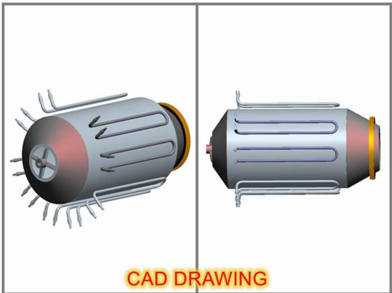
Pipa pemanasan elektrik yang padat mengelilingi keseluruhan drum fiksasi untuk memastikan kepanasan seragam papan silinder, pemasangan teh lebih sekata.
