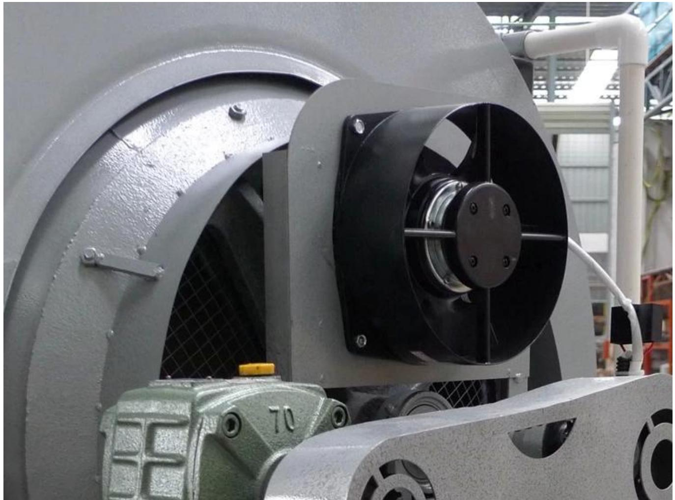
Kipas ekzos ditambahkan ke belakang, yang dapat dihidupkan dan dimatikan secara manual, yang dapat dengan cepat meniup udara panas dan lembap di dalam mesin untuk mengelakkan teh tersumbat dan mempengaruhi rasa
