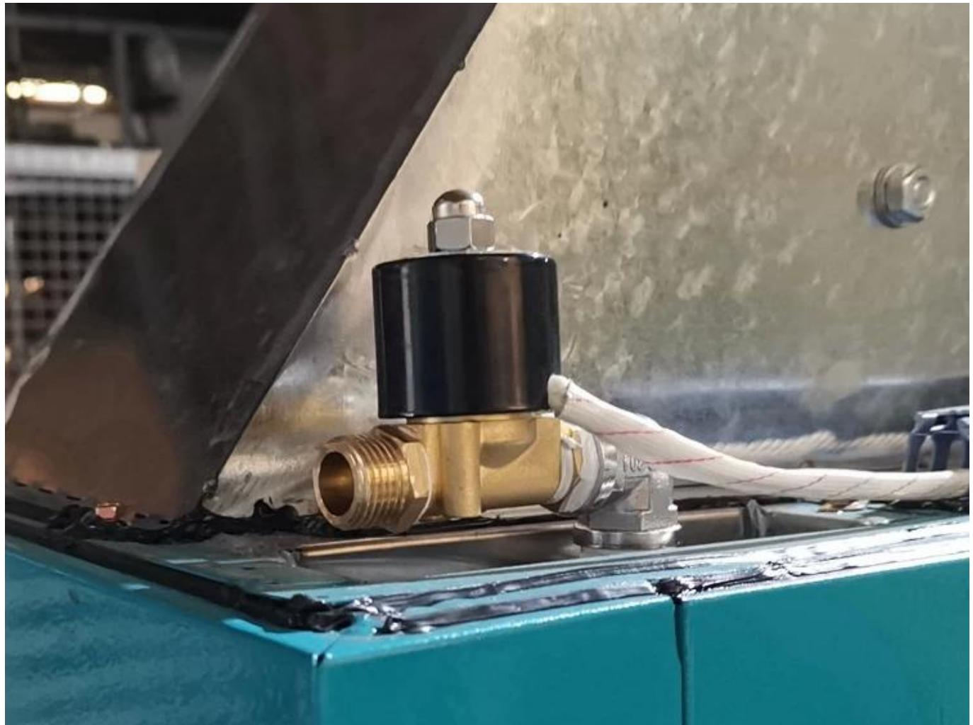
Reka bentuk solenoid valve memastikan bahawa air di dalam tangki disimpan pada ketinggian atomisasi terbaik.
