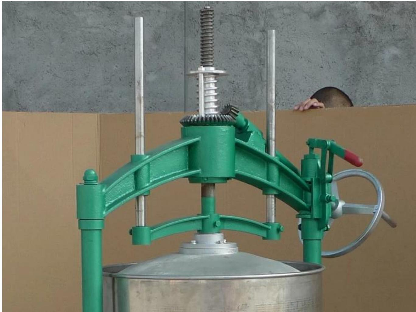
Lengan ganda menggunakan struktur penutup terbuka lengan dua, yang mempunyai kapasiti galas yang kuat dan operasi yang stabil.
