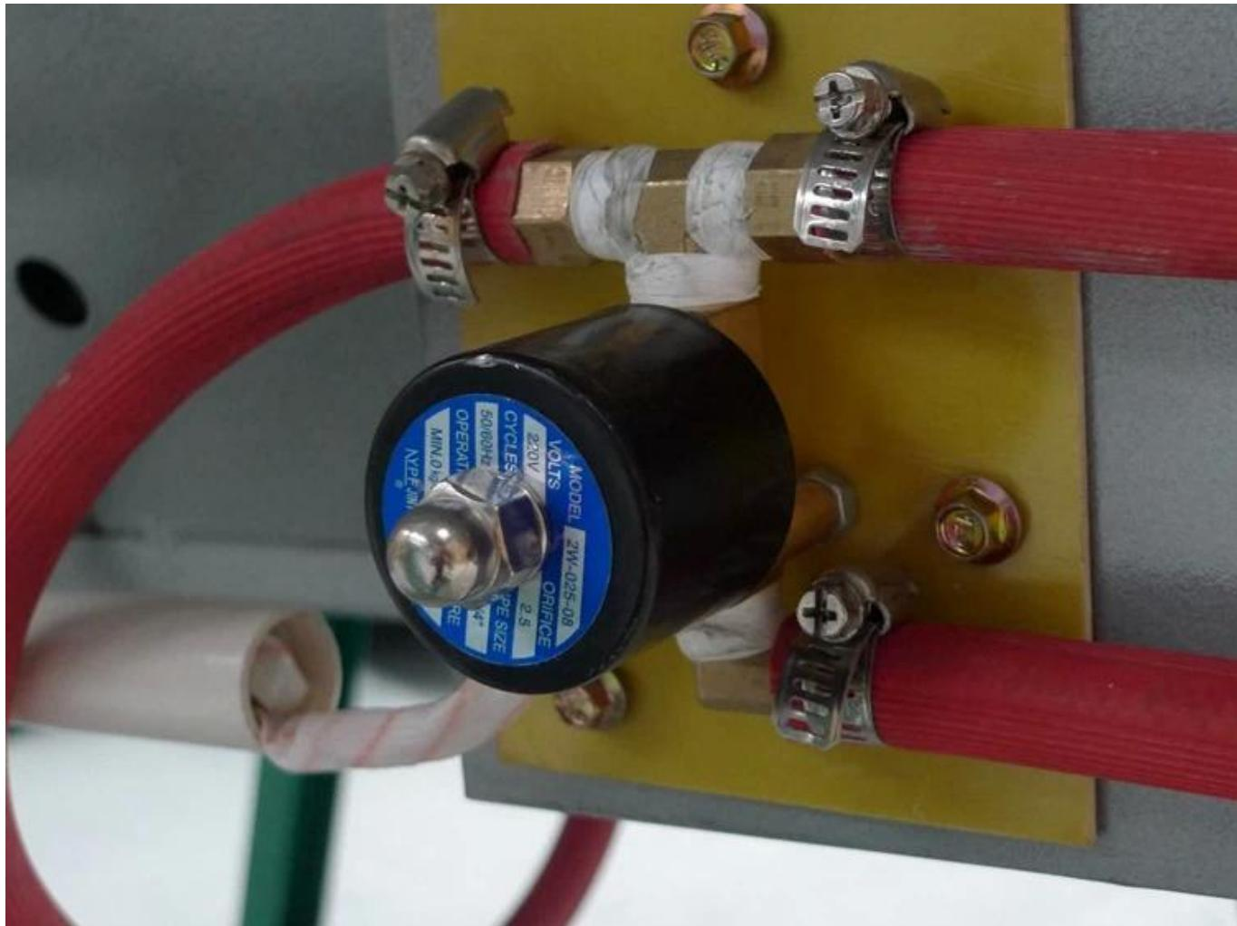
Reka bentuk solenoid valve automatik, pemanasan secara automatik bermula dan berhenti, solenoid valve ditutup secara automatik apabila suhu mencapai suhu yang ditetapkan, dan mesin berhenti pemanasan. Apabila suhu lebih rendah daripada suhu yang ditetapkan, injap solenoid terbuka dan mesin dipanaskan semula, yang dapat menjimatkan bahan bakar.
