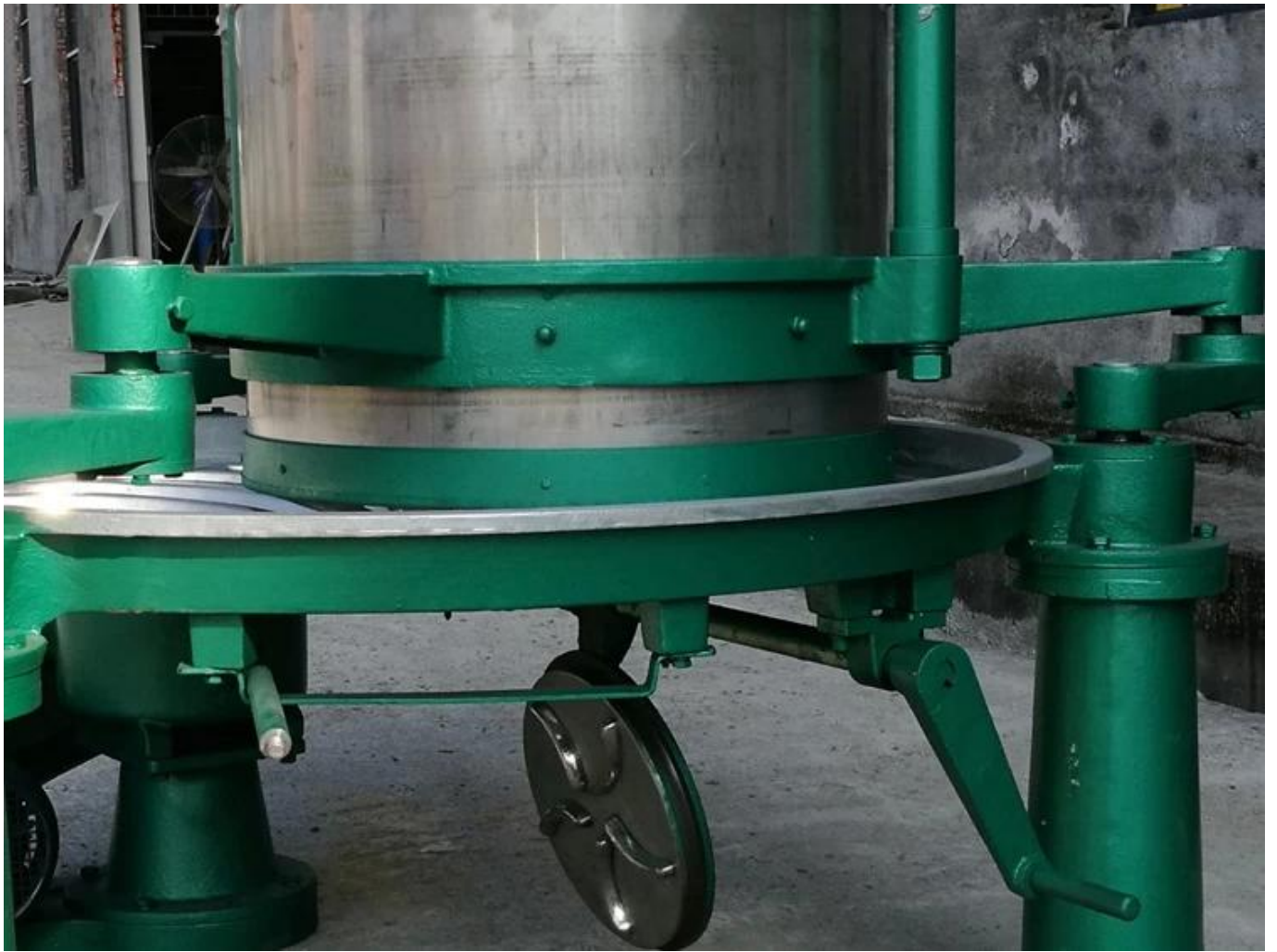
Bahagian sokongan mesin diperbuat daripada besi tuang, yang kuat dan tahan lama.
