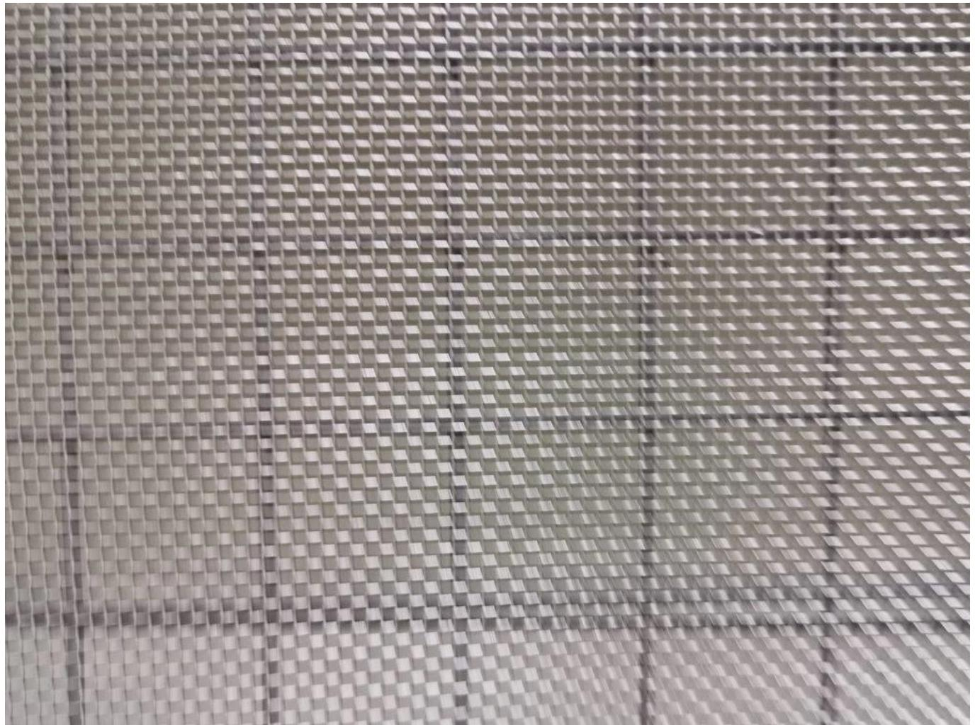
Plat mesh keluli tahan karat yang halus digunakan untuk memastikan kelantangan udara dan menyaring daun yang patah sangat kecil.
