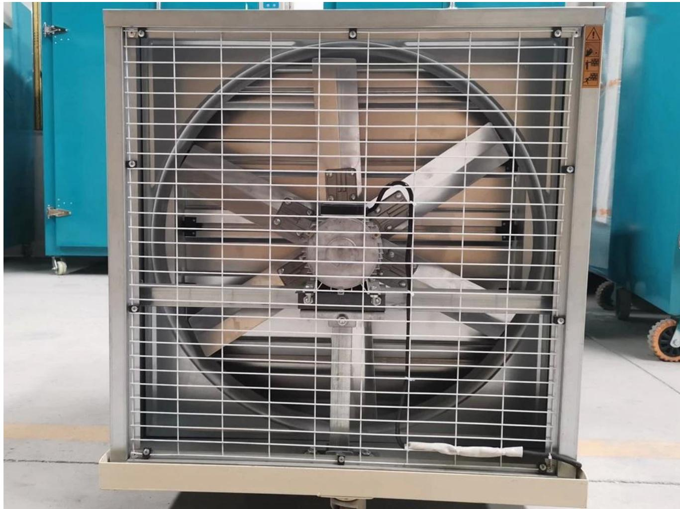
Kipas aliran paksi vakum isipadu udara yang besar, dengan isipadu udara yang besar, memastikan bahawa udara panas dapat ditiuup ke seluruh palung layu, dengan kelajuan yang dapat disesuaikan dan operasi yang stabil tanpa bunyi.
