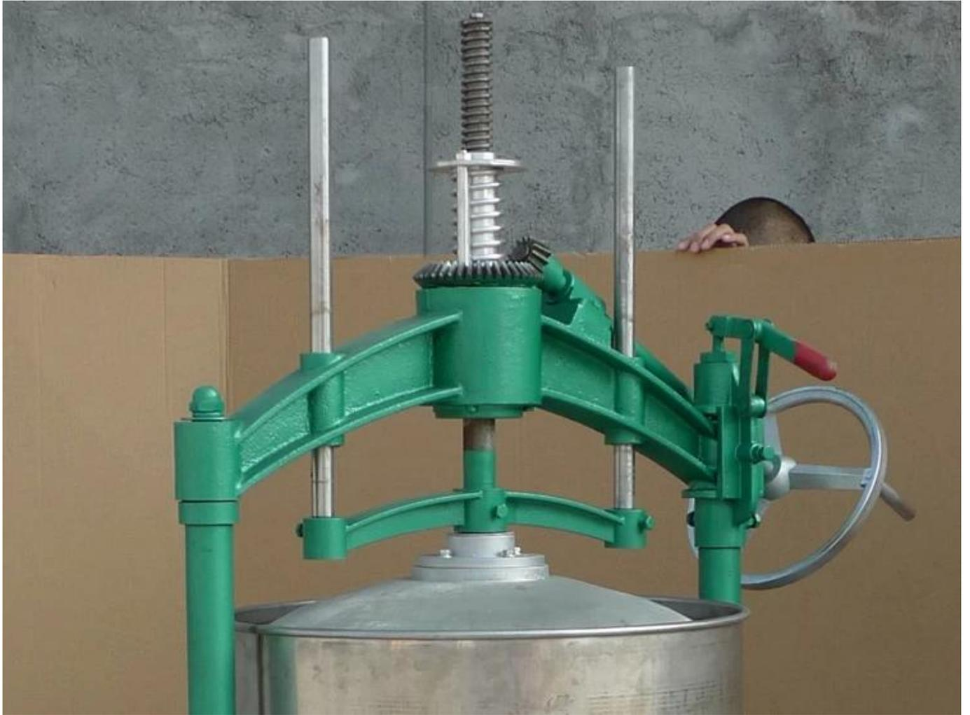
Lengan ganda menggunakan struktur penutup terbuka lengan dua, yang mempunyai kapasiti gelas yang kuat dan operasi yang stabil.
