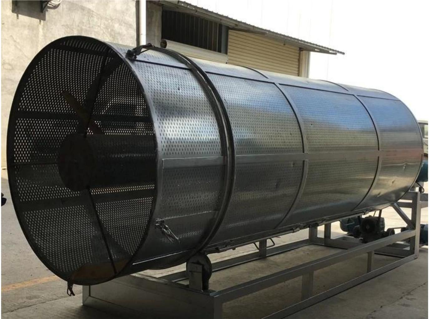
Kerangka sokongan dalaman meningkatkan kekuatan struktur mesin dan mengurangkan getaran semasa digunakan.
